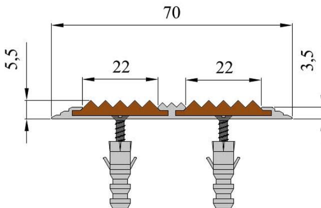
Технические размеры полосы с двумя вставками против скольжения 70 мм/5,5 мм
